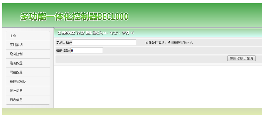
图 4-6 WEB 模拟量监测点配置
